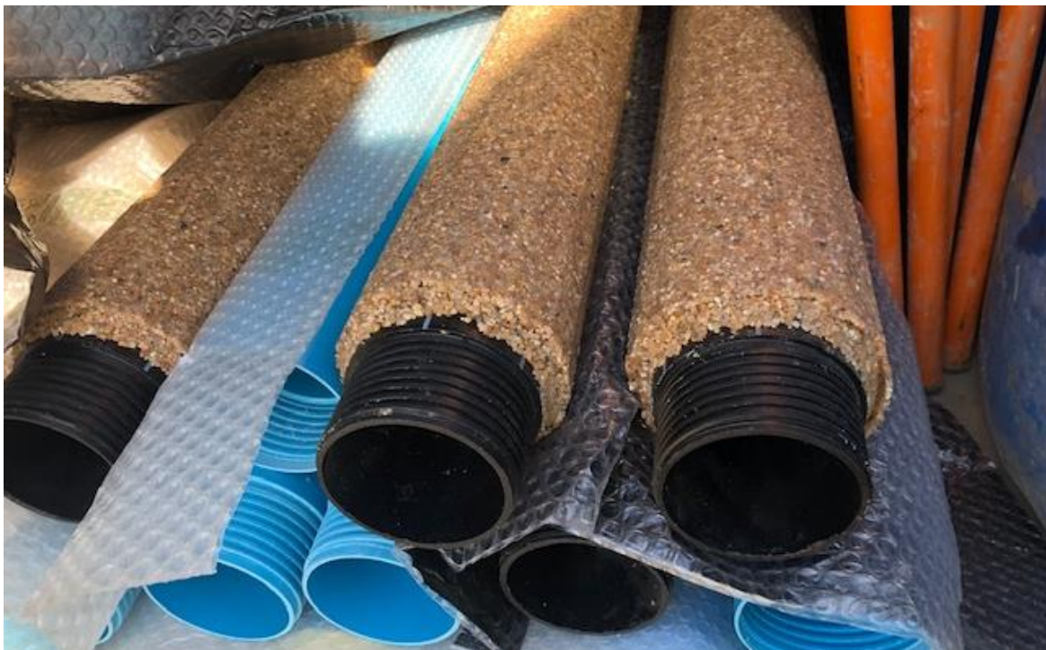
Figura nº 5. Detalle de empaque de tubería filtrante del dispositivo de control del lixiviado
