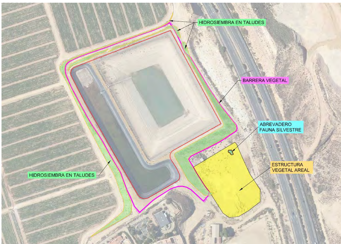
Figura 60. Replanteo medidas compensatorias frente a las afecciones a la flora y vegetación. Balsa Vera
