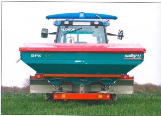
Figura 17 – Abonadora centrífuga equipada con un conjunto de sensores de luz reflejada. La radiación recibida permite determinar las zonas carentes de nutrientes y regular la dosis de abono en consecuencia.
