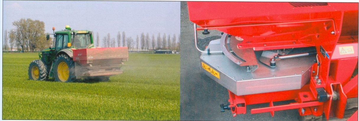
Figura 18 – Abonadora centrífuga de doble disco durante una distribución variable.
