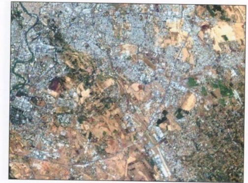
Figura 17a – Composición en varios colores de una imagen LANDSAT utilizando la banda 321 en RGB. La coloración de la imagen respeta los colores naturales como en una fotografía.
