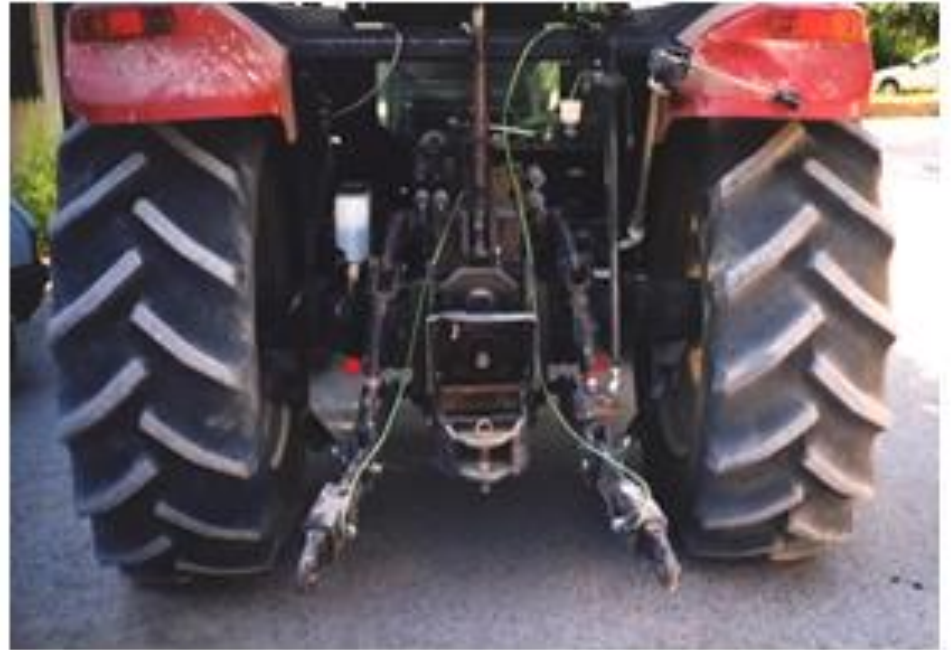
Fotografía 12.-Ejes dinamométricos instalados en los brazos de tiro.
