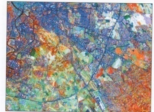
Figura 17c – La misma imagen con la introducción de la banda 5 del verde permite obtener más información de la vegetación. Varias tonalidades de naranja desde claro
