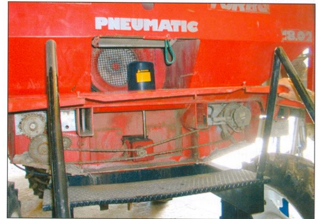
Figura 20 – Actuador eléctrico para variar la velocidad de giro del distribuidor en una abonadora neumática.
