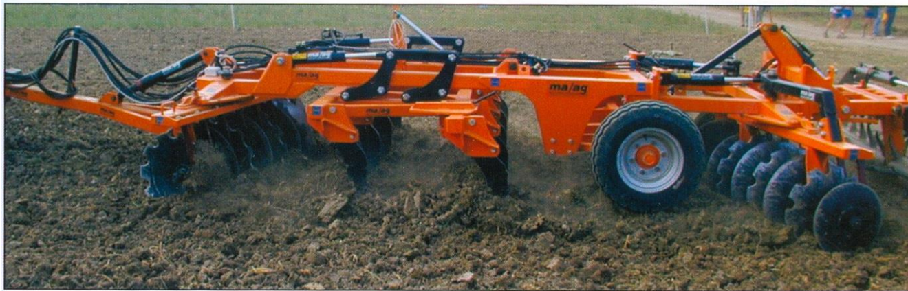
Figura 15 – Aperos de labranza capaces de variar de forma continua la profundidad de trabajo. Esto es posible gracias a la presencia de cilindros hidráulicos comandados por la unidad de control que varían la altura del bastidor secundario del apero respecto al principal.
