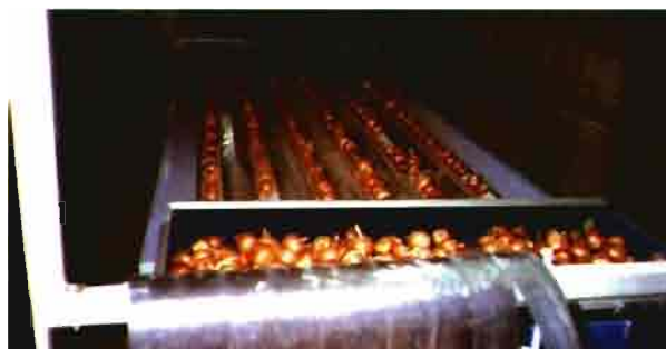
Detalle de la alineación y alimentación del calibrador electrónico de peso de cebollas. Foto: Tecnofruta Levante S.L.
