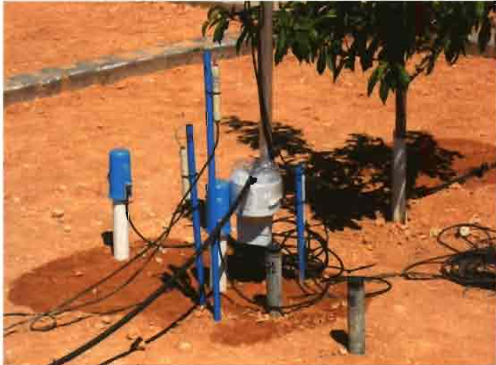
Foto 2. Equipamiento para la medida de agua en el suelo.
