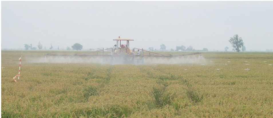
Foto 3. Tratamiento con equipo de tratamiento terrestre con boquillas cónicas. Foto: G. Galimany.
