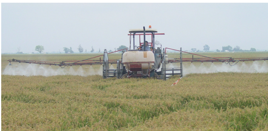
Foto 4. Tratamiento con equipo de tratamiento terrestre con boquillas de abanico. Foto: G. Galimany.
