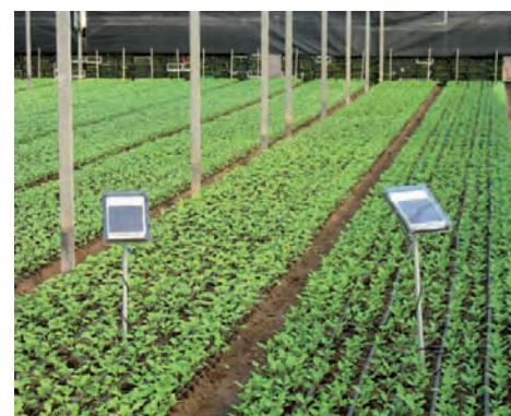
Placas solares para la alimentación de los sensores de medición de humedad del suelo
