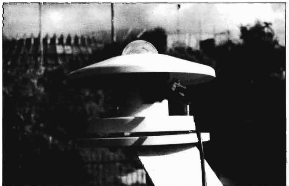
FIGURA 3: Sensor puntual de radiación solar global. (Equipo perteneciente a la Unidad Docente de Botánica Agrícola de la E.T.S.I. Agrónomos de Madrid).
