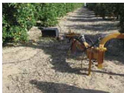
Figura 12. Desbrozadora de latiguillos para los pies de los árboles.
