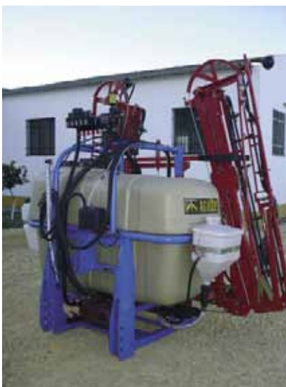
Figura 14. a) Pulverizador hidráulico de chorro proyectado con regulador de presión. b) Equipo con control electrónico y depósitos auxiliares.
