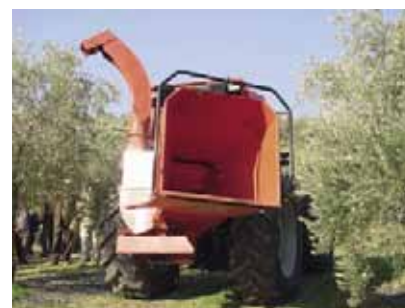
Figura 8. Trituradoras de alimentación manual mostrando el túnel de entrada de leña
