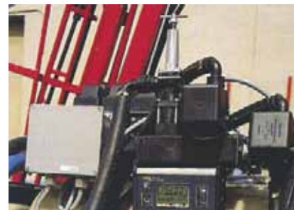
Figura 16. Sistema de regulación electrónico proporcional al avance
