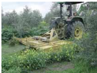
Figura 9. Desbrozadora de cadenas de ejes vertical y mecanismo de plegado
