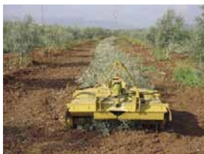
Figura 6. Trituradora autoalimentada de eje vertical de cuchillas accionada por la toma de fuerza
