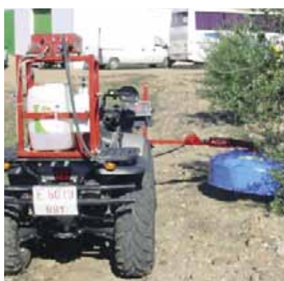
Figura 22. a) Boquilla centrífuga. b) Montaje en tractocarro
