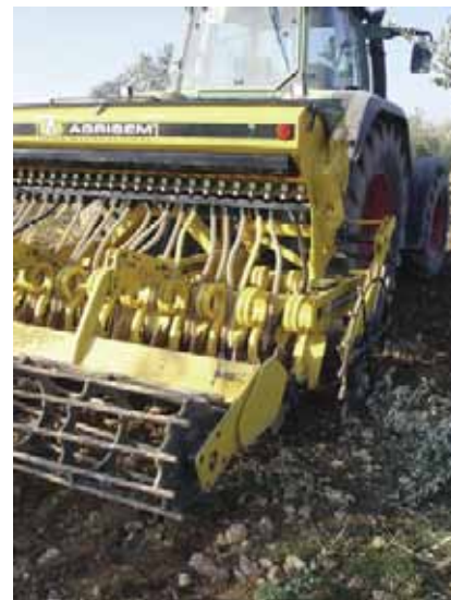
Figura 3. Sembradora de chorrillo adaptada para la siembra de cubiertas vegetales. Tren de siembra: discos escotados montados sobre brazos de cultivador y rulo de jaula
