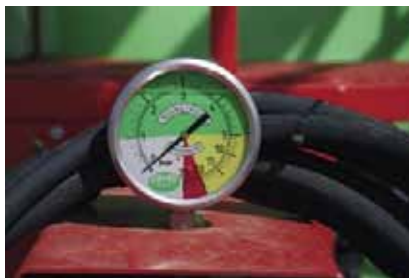
Figura 15. Manómetro con suficiente resolución para la aplicación de herbicidas (1-5 bares).
