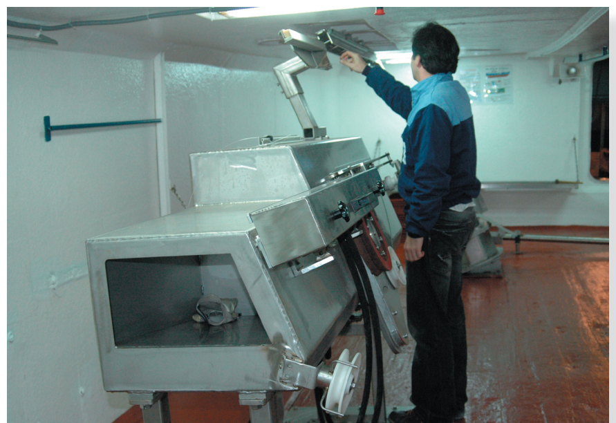
Pruebas en la máquina que automatiza la recogida.
