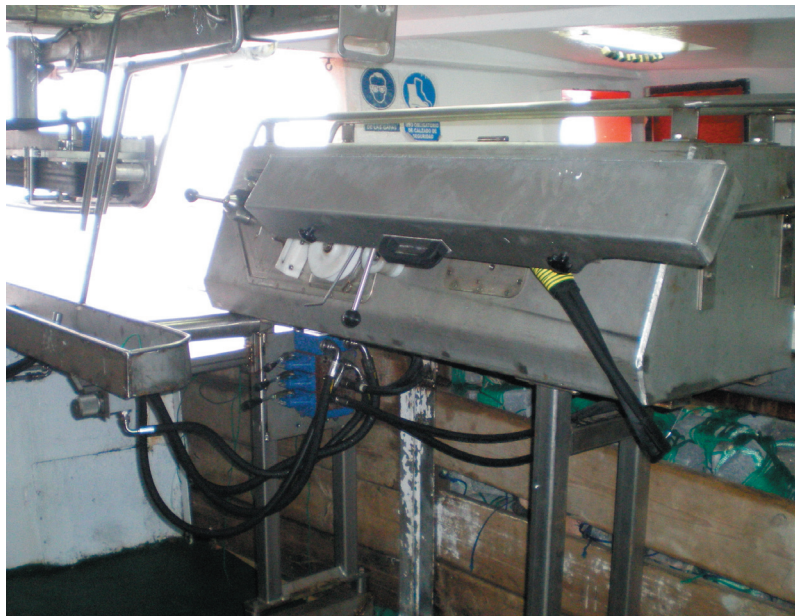
Maquinaria automatizada para largada y recogida de aparejo a bordo del Santiago Apóstol.
