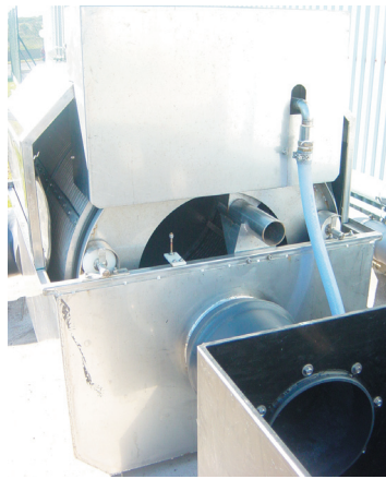
Filtro rotativo de malla 60 µm y capacidad 350-450 m 3 /h.
