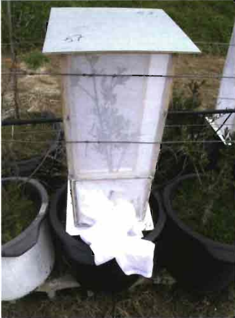
Figura 1. Cajas utilizadas en los ensayos de persistencia que protegen a los olivos de la lluvia.
