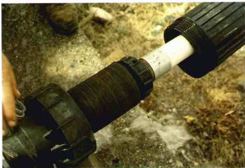
Fig. 11.-Limpieza filtro de discos o anillas. Una vez separadas las anillas o arandelas, se les somete a chorro de agua.
