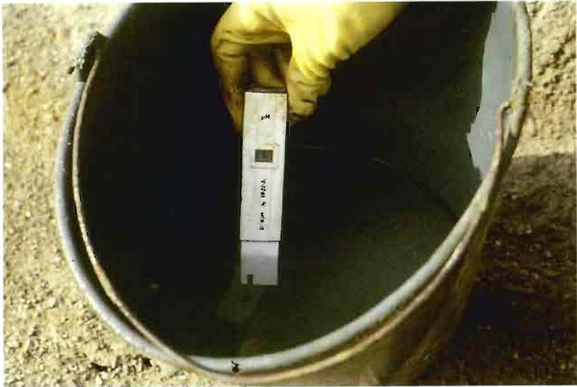
Fig. 25.-Comprobación del pH del agua.
