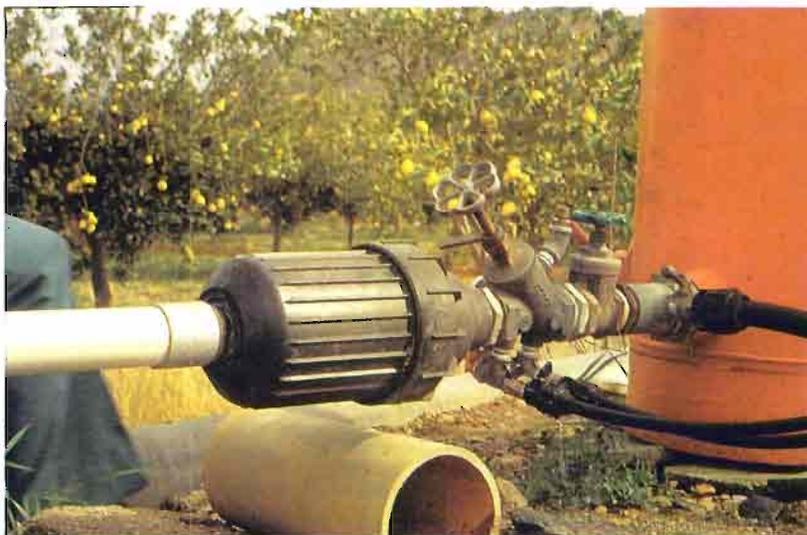
Fig. 10.-Filtro de discos o anillas. Estos filtros se montan horizontalmente y en línea.
