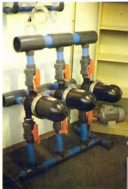
Fig. 12.—Batería de filtros de anillas.
