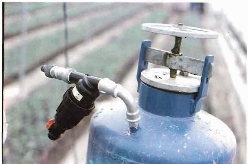
Fig. 13.-Detalle pequeño filtro de plástico conectado a una abonadora para retener cualquier partícula insoluble en la solución fertilizante.
