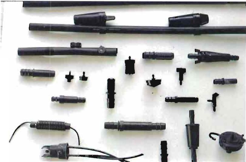
Fig. 17.-Muestrario de goteros empleados en riego por goteo.
