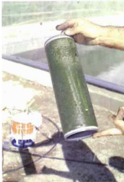
Fig. 26.–Filtro de malla. Se aprecia la suciedad acumulada.
