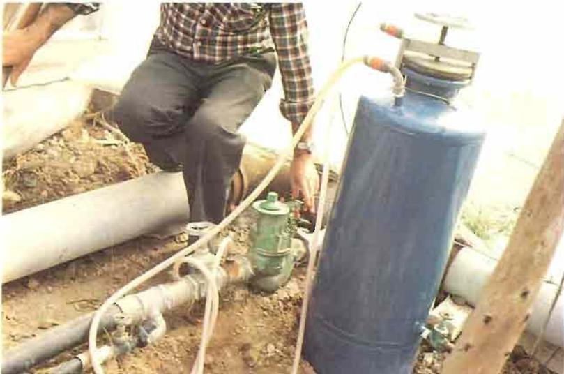
Fig. 14.-Abonadora de hierro. Se aprecian las conexiones a la red de riego.
