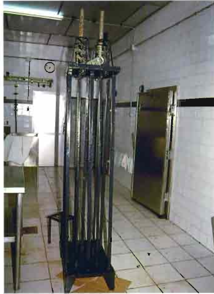
Fig. 9.– Prensa vertical de muelles, con cuatro columnas.
