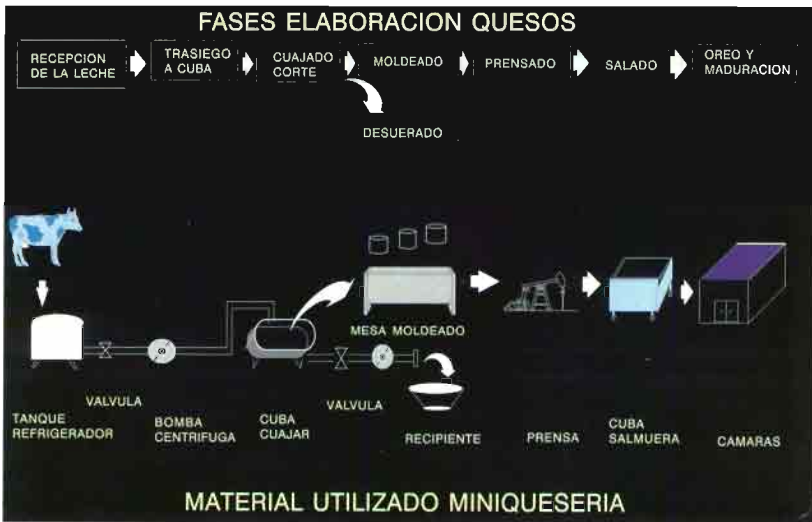
Fig. 5.-Esquema de las fases de elaboración y material utilizado en las miniqueserías.
