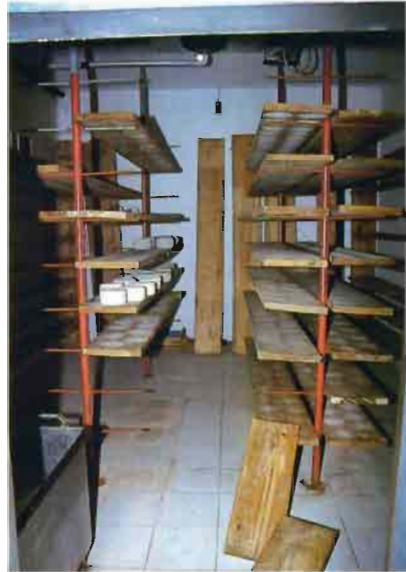
Fig. 15. – Disposición de soportes y baldas de madera en el interior de una cámara de maduración.
