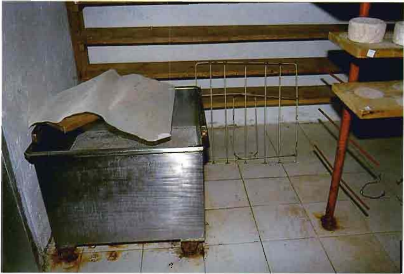
Fig. 11.—Depósito de salmuera, rejilla y malla. En sus ruedas se observan los inconvenientes de no estar fabricados en acero inoxidable.
