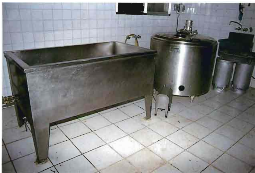
Fig. 7.– Cuba de cuajar pasteurizadora de forma rectangular, tanque de frío y bomba de trasiego.
