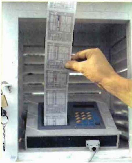
Fig. 9.-Obtención de forma impresa de los datos elaborados por una miniestación de alerta.
