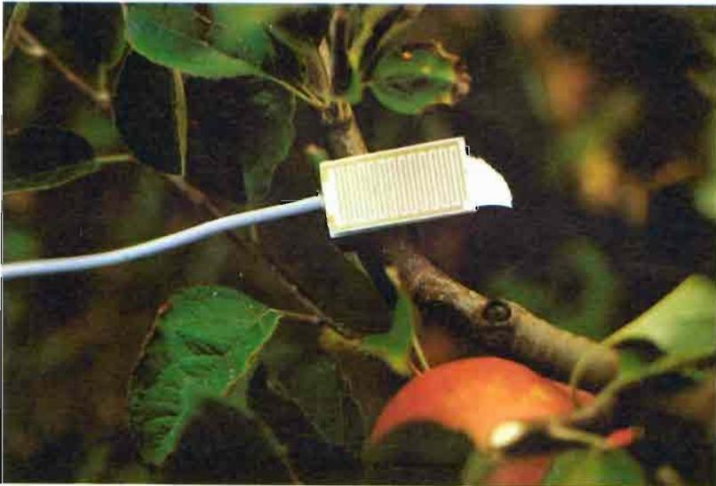
Fig. 13.-Sensor foliar de humedad y temperatura.
