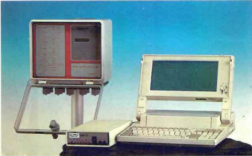
Fig. 3.-Transferencia de datos desde la estación meteorológica al ordenador personal.
