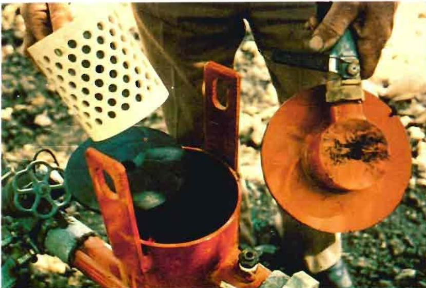
Fig. 6.-Filtro de malla desmontado.
