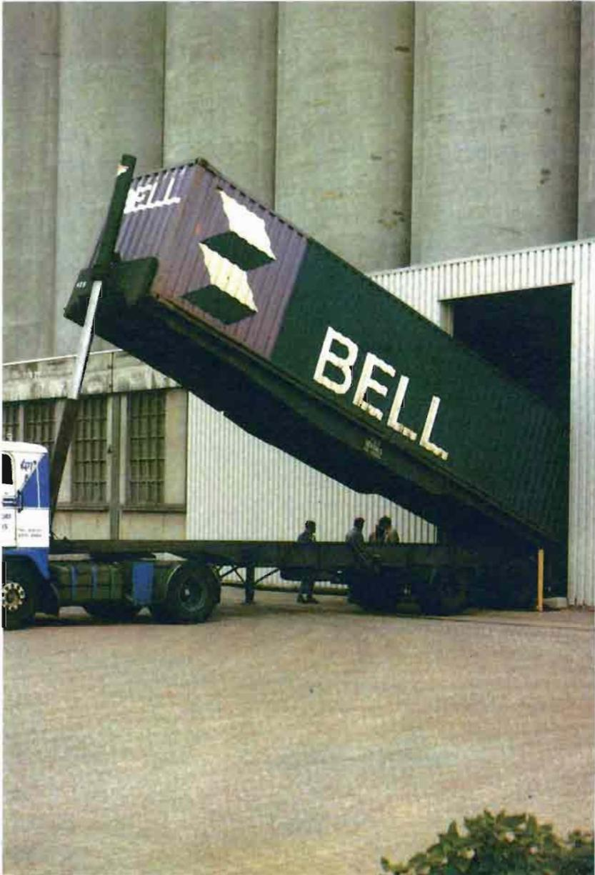
Fig. 5.-Descarga de materia prima en silos de una fábrica de pienso compuesto.
