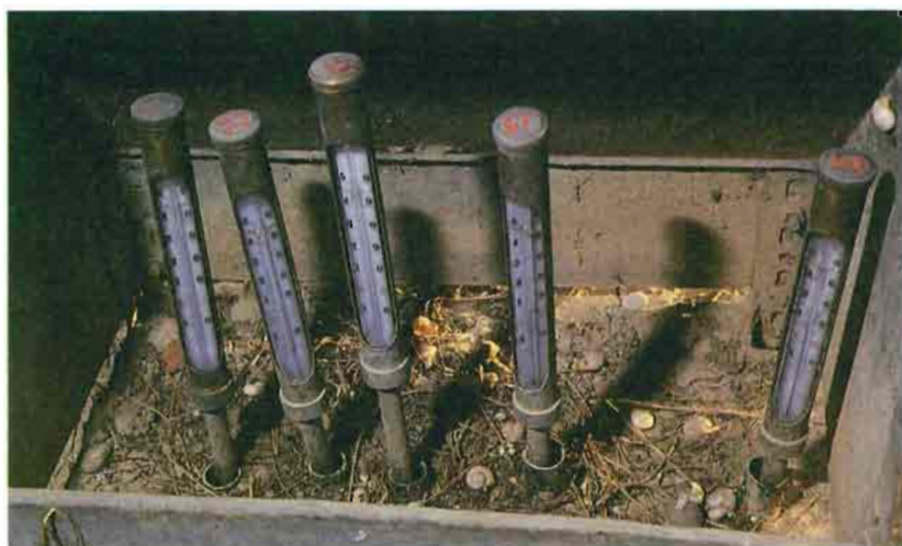
Fig. 4. Termómetros para controlar la temperatura del suelo a diversas profundidades.
