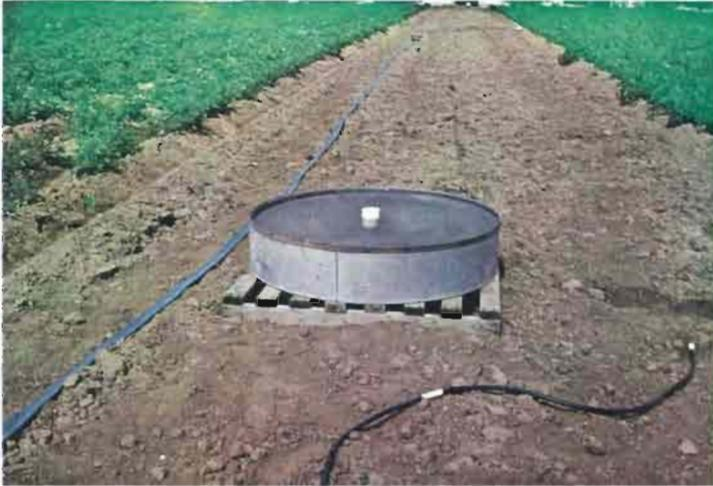
Fig. 8.—Cubeta evaporimétrica.
