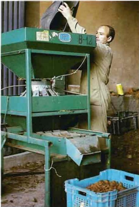
Fig. 2.—Despellejado de la almendra con máquina.
