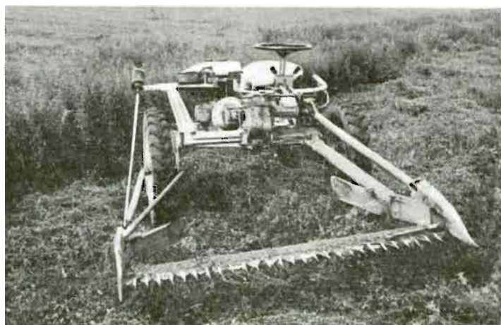
Foto 6.—Motosegadora de corte frontal para la siega de alfalfa.
