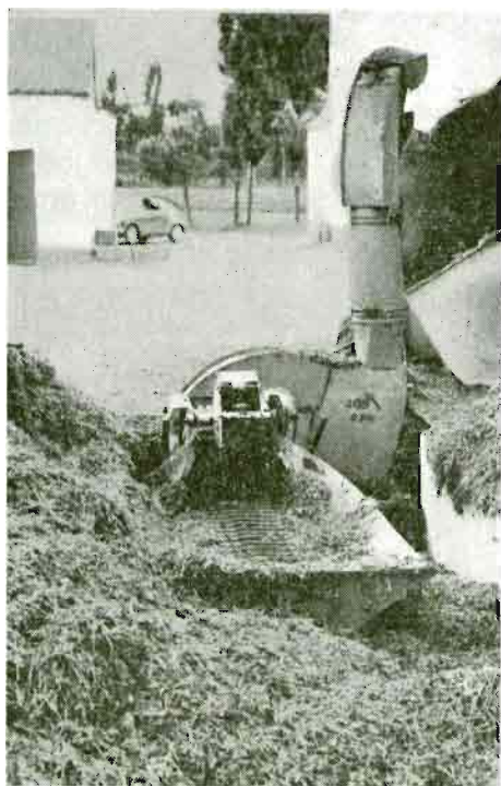
Foto 8.—Picadora cargadora de una deshidratadora de alfalfa.
