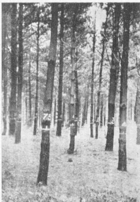
Sitio de ensayo: Lezama. Parcela B.—En la foto se ven los árboles de la parcela numerados y con sus anillos pintados a la altura normal (1,30 m.).
