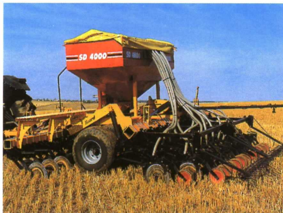
Discos en 'v' con cuchilla abridora.
