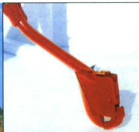
Bota de siembra y detalle de la compuerta posterior de cierre.
