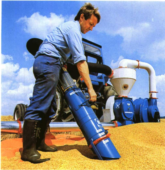
Transporte neumático: flexible y de gran alcance.
