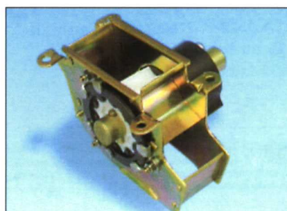
Siembra a chorrillo: a) Detalle del fondo de la tolva con las salidas hacia el dosificador. b) Dosificador continuo para siembra a chorrillo.
