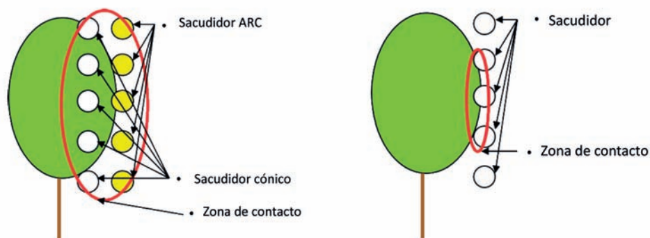
Figura 1/ Esquema comparativo del sistema de sacudidores Grégoire (a la izda. de la imagen), con otros sistemas (dcha.)
