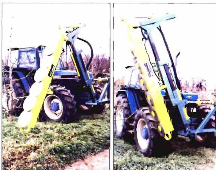
Foto 5. Prepodadora de discos cuyo brazo puede adoptar diversas inclinaciones para cortar el lateral de los árboles.
