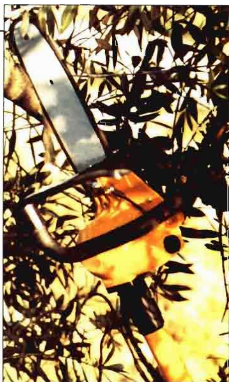
Foto 6. Motosierra con accionamiento neumático colocada en el extremo de una pértiga por cuyo interior circula el aire a presión.
