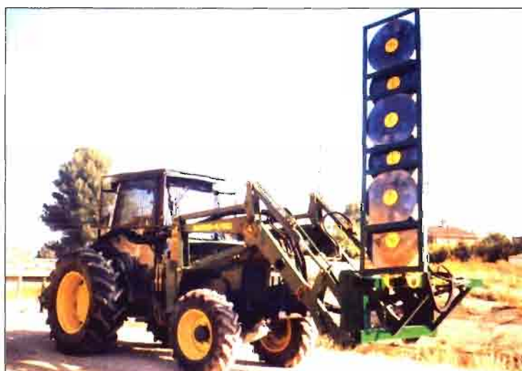
Foto 4. Prepodadora de discos montada delante de los brazos de una pala, con protección en la cabina del tractor y en los discos.
