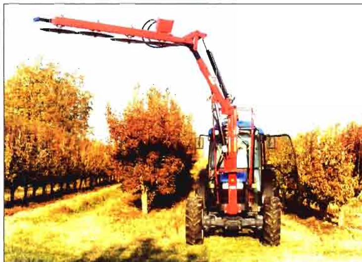
Foto 3. Prepodadora de discos dentados; muestra la altura que puede alcanzar sobre el suelo para desmochar la parte alta de las copas.
