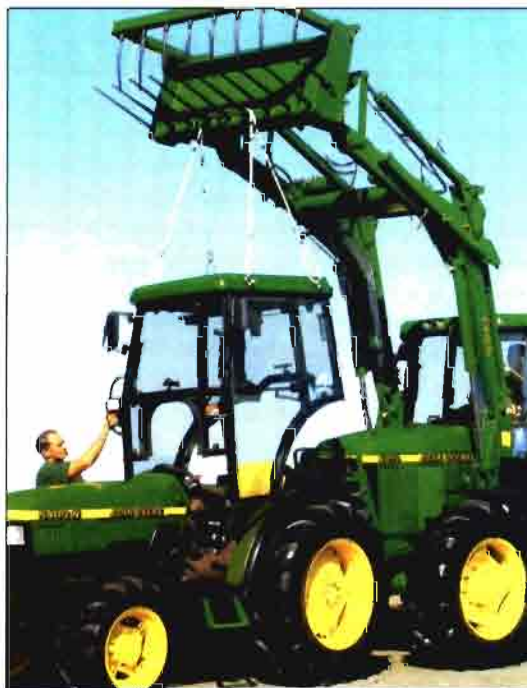
Foto 3. Algunos tractores estrechos ofrecen la posibilidad de retirar e instalar la cabina con relativa facilidad.
