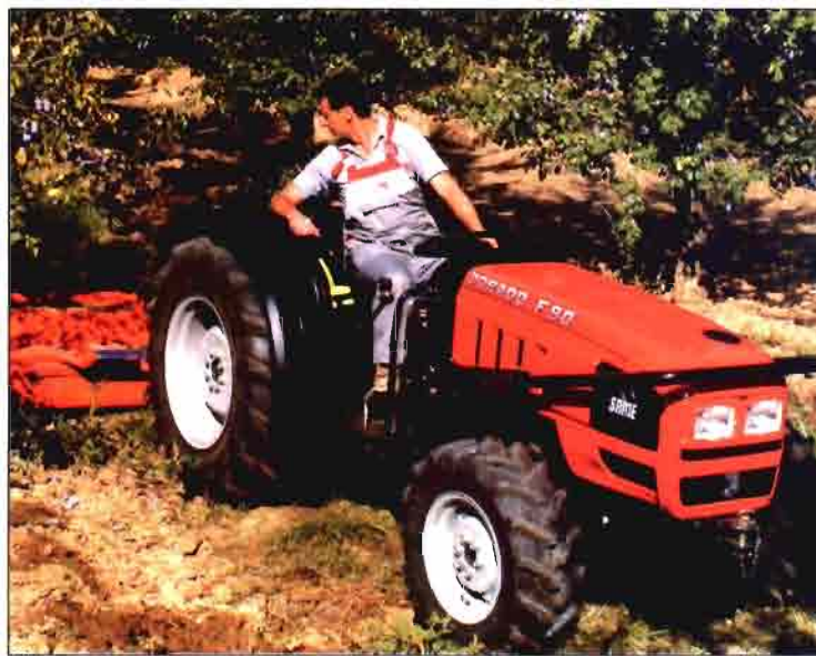
Foto 2. Arco de seguridad abatido hacia adelante para evitar tropezar con las ramas.
