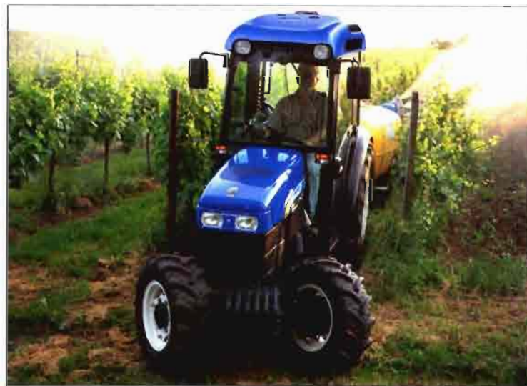
Foto 4. Tractor mostrando el gran ángulo de giro que pueden alcanzar las ruedas directrices.
