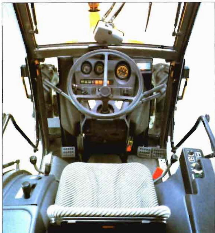
Foto 9. Relativa amplitud en el puesto de conducción a pesar de la cabina y la presencia de los mandos.
