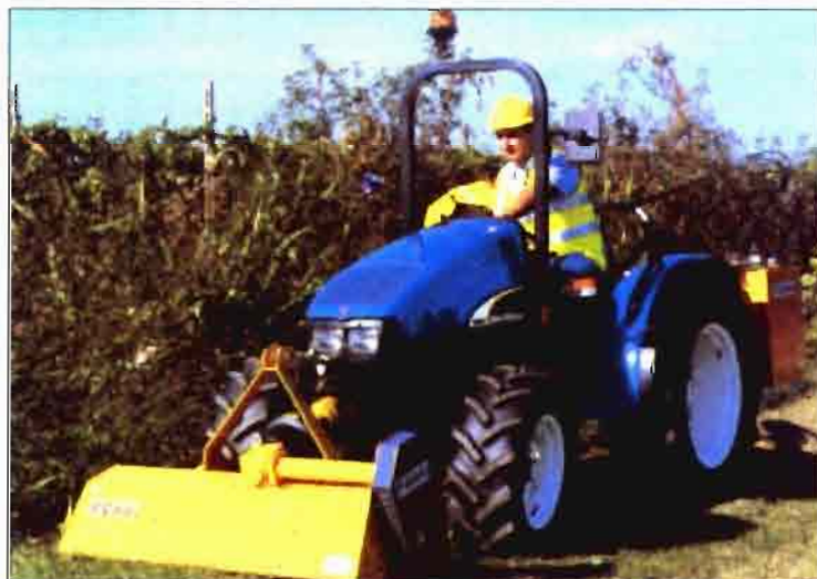
Foto 5. Enganche tripuntal delantero suspendiendo un apero, accionado por la toma de fuerza delantera.
