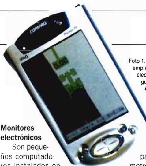
Foto 1. Los ordenadores de bolsillo se emplean ya como monitor electrónico en los sistemas de guiado y para realizar mapas de rendimiento. (Documentación Intrac).
