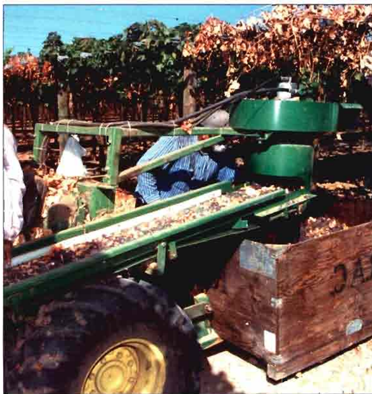
Los rollos de papel con las pasas dentro pueden ser volcados a palots mecánicamente, a la vez que se eliminan hojas y raspones. (Foto: P. Christensen).
