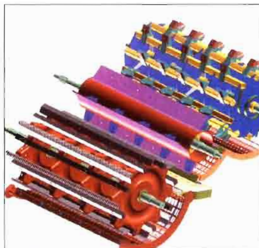
▲ Figura 4. El sistema MCS de Laverda incrementa las prestaciones de las máquinas al separar los granos del producto antes de que llegue al sacudidor.
