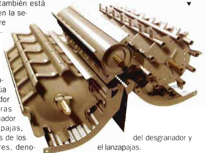
▲ Figura 3. La trilla mejorada de las CS de New Holland se basa en un cilindro separador rotativo transversal detrás de los elementos convencionales (desgranador y lanzapajas).
