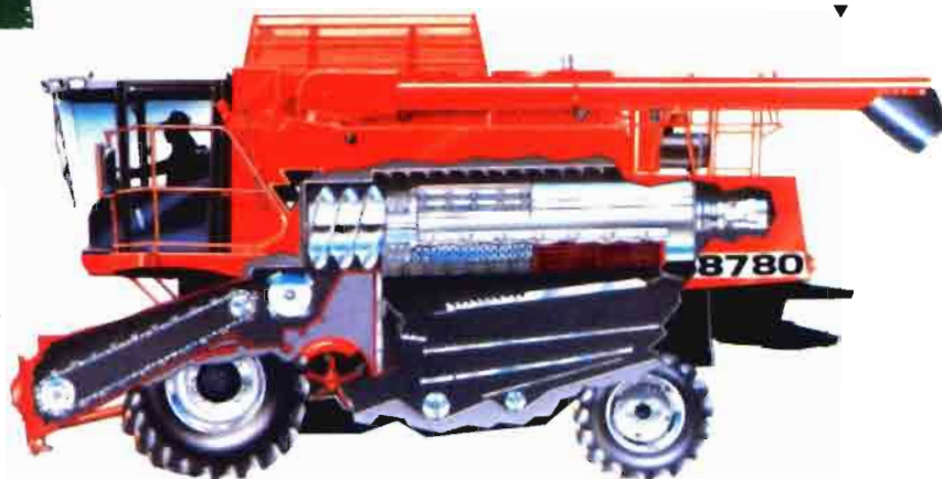
Figura 7. La Massey-Ferguson 8780 es difícil de ver en España. Consta de un único rotor de trilla-separación rotativa longitudinal, alimentado por un pequeño cilindro de alimentación bajo su extremo delantero.
