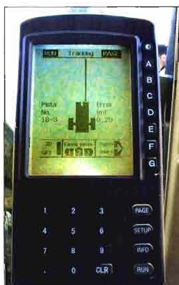
El monitor informativo de John Deere, con indicación de la pasada actual, el rumbo a seguir y el error cometido en cada instante.
