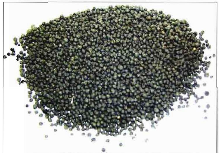
Lodo secado térmicamente.
