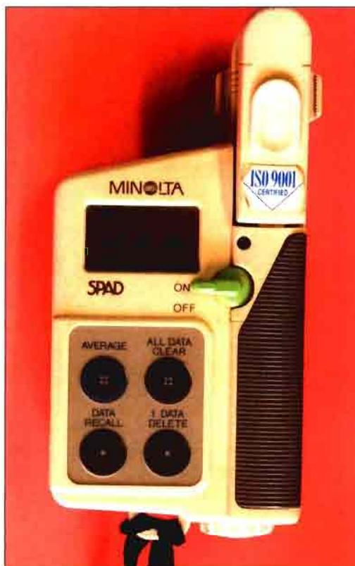
Foto 4. Medidor de clorofila SPAD.
