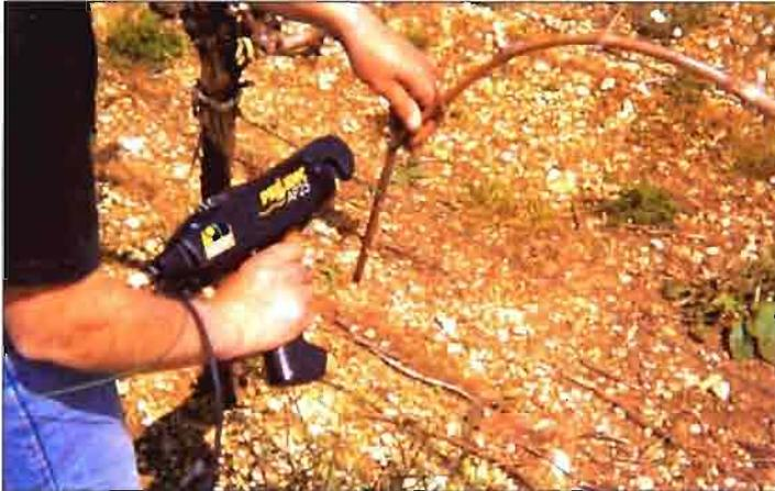
Foto 6. Atadora de sarmientos a los alambres con accionamiento eléctrico.
