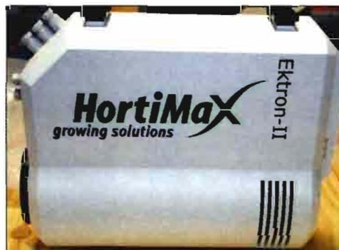
Foto 4. Dispositivo para la medida de la temperatura, humedad y concentración de CO<sub>2</sub>.
