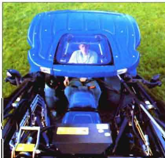
► Con la cabina Horizon™ se puede ver la carga en su altura máxima de elevación gracias al panel transparente que hay en el techo.
