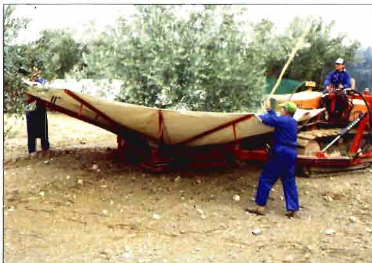
Foto 5: Vareadores complementando la acción de un vibrador con paraguas.
