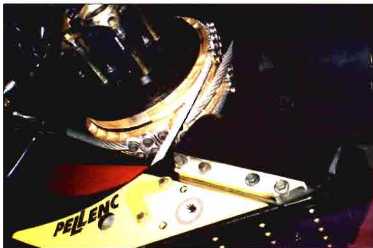
Foto 4: Vibrador con cables de acero para mantener el apriete de la pinza.
