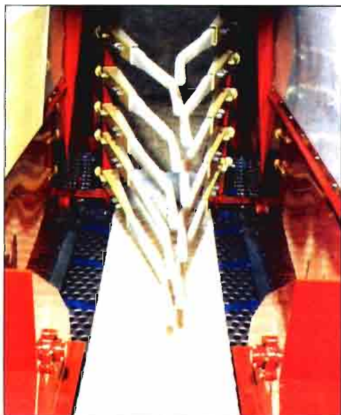
Foto 2: Varillas sacudidoras acodadas de ALMA y escamas imbricadas bajo ellas.
