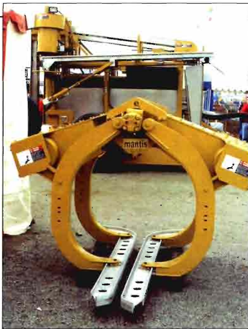
Foto 6: Dispositivo de vendimia con barras oscilantes que sacuden la base de los troncos utilizado en Estados Unidos.
