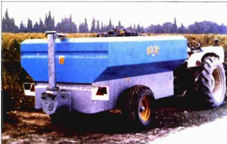
Foto 8: Remolque de vendimia con una cámara inferior donde se acumula el mosto y los granos quedan arriba.
