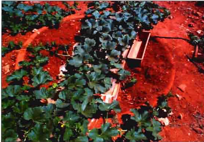
Lisímetro de pesada con planta de melón para la medida del consumo de agua.
