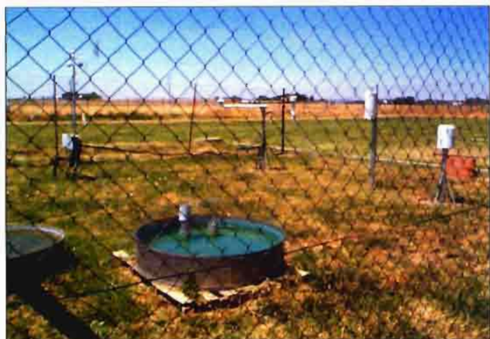
Estación meteorológica automática con evaporímetro para el cálculo de la ETc.
