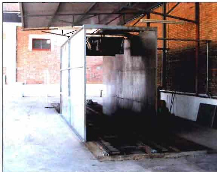
Sistema de aplicación de fungicidas mediante ducha ("drencher").
