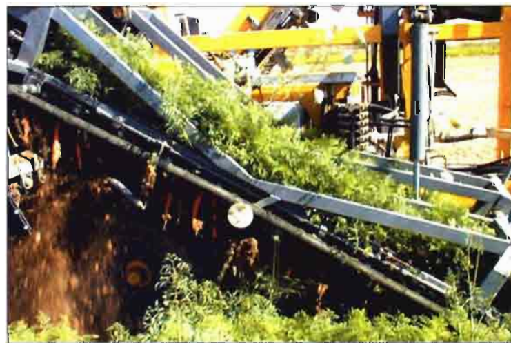
Foto 15. Cosechadora arrastrada de dos filas de zanahorias Hidagri.
