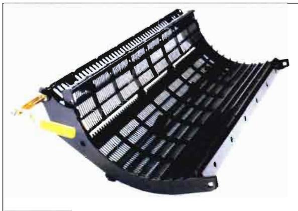
Accionando la manivela del dispositivo Opti Thresh de las New Holland CS, el operario desplaza la parte final del cóncavo para dañar menos la paja.
