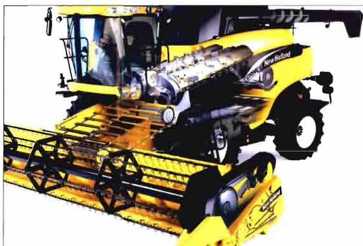
La serie CR de New Holland dispone de dos rotores longitudinales para sustituir a cilindro desgranador y sacudidores.
