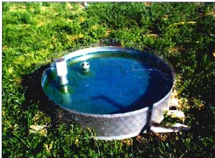
Evaporimetro de cubeta clase A.
