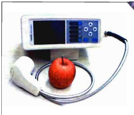
Espectrofotómetro de sobremesa para la detección no destructiva de azúcares en fruta de la casa Fantec.
