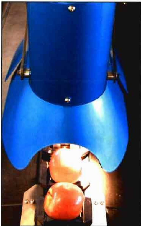
Espectroscopia de reflectancia NIR (infrarrojo cercano) en línea para la estimación de sólidos solubles (azúcares) comercializado por la empresa Compac.
