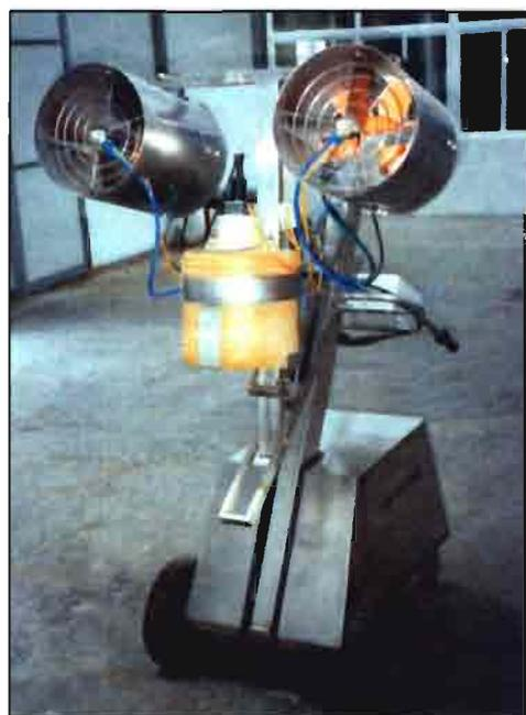
Figura 10. Atomizador desplazable manualmente
