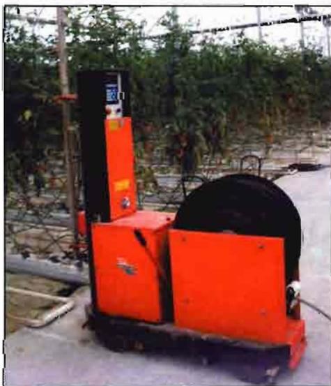
**Figura 7. Pulverizador eléctrico autopropulsado y autónomo.**
