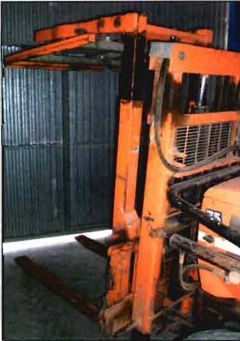
Figura 2. Horquilla hidráulica frontal.
