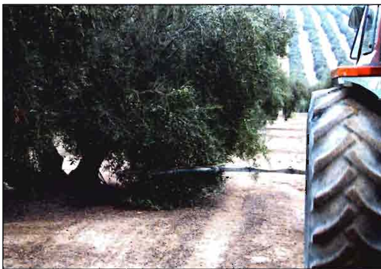
Detalle de una barra diseñada para la aplicación de herbicidas en olivar. El mecanismo hidráulico permite situar las boquillas a la distancia idónea del suelo. La punta de la barra es abatible y permite doblarse y recuperarse a su posición inicial en casos de choque contra un obstáculo, como los troncos del olivo. La barra puede entrar bajo la copa de los árboles y sin romper las ramas péndulas (como se ve en la segunda fotografía), lo que asegura además que no queden zonas sin tratar.
