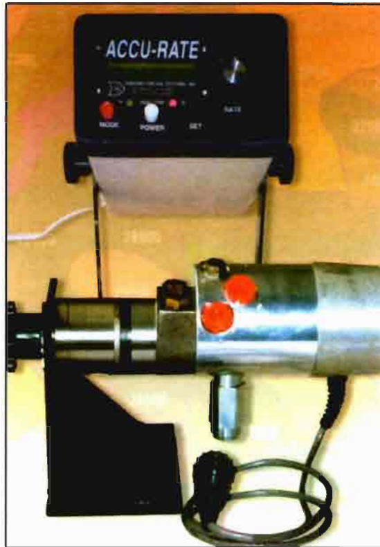
Figura 2. Accionamiento para la aplicación de dosis variable. Puede ser instalado en sembradoras, abonadoras e incluso pulverizadores y se encarga de ajustar automáticamente la dosis según el mapa de aplicación y el GPS (ACU-Rate, Rawson)
