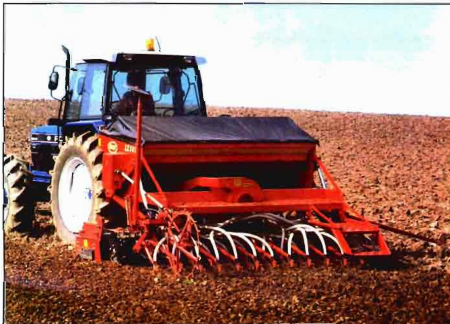
Sembradora trabajando con un marcador de huella levantado (el derecho) y el otro dejando un pequeño surco en el suelo (el izquierdo).
