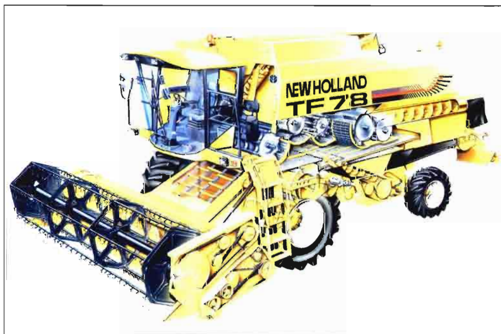
F. 6. Cosechadora de separación rotativa con el cilindro transversal de doble flujo (penúltimo por detrás), situado después de los cilindros de trilla (TwinFlow de NewHolland).
