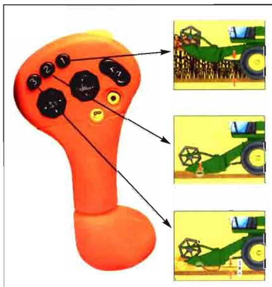
F.1. Las palancas de control del sistema automático de nivelación permiten programar funciones útiles, adaptándose a los diversos tipos de cultivo (CTS de John Deere).
