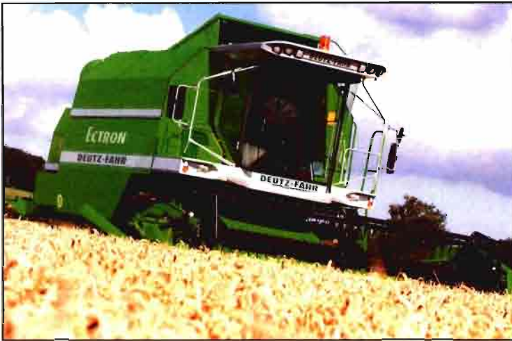
F.2. Para el trabajo en ladera se utilizan sistemas de compensación automáticos que corrigen el efecto de la pendiente, mejorando el rendimiento de limpia (serie Ectron de Deutz-Fahr).
