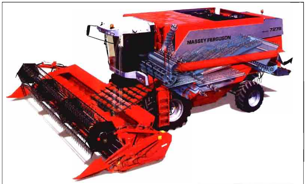
F.4. Aún en cosechadoras con separación tradicional mediante sacudidores, al sistema de trilla se le añaden cilindros (de dedos, en este caso) que realizan una labor mixta entre trilla y separación (Massey Ferguson 7200).
