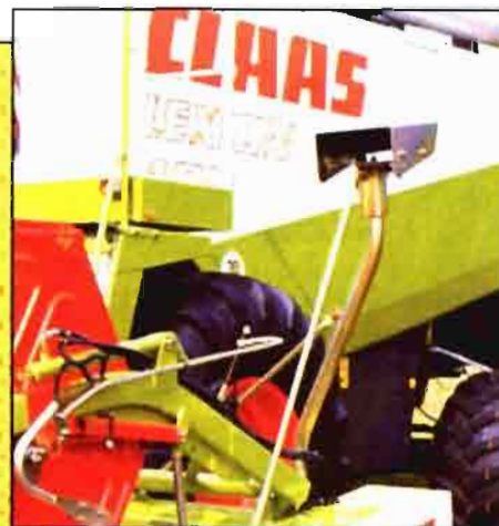
F. 7. El guiado automático de la cosechadora se realiza gracias a los rayos láser enviados hacia la mies y el rastreo por un sensor montado sobre el extremo del cabezal (Laser Pilot de Claas).
