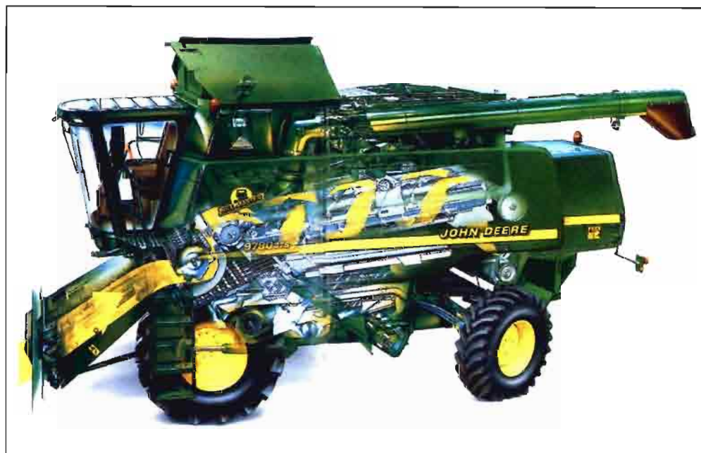
F. 5. Cosechadora de separación rotativa con dos cilindros longitudinales de dedos en rotación opuesta, situados detrás del sistema de trilla tradicional de cilindro transversal desgranador, batidor y cilindro auxiliar (CTS de John Deere).
