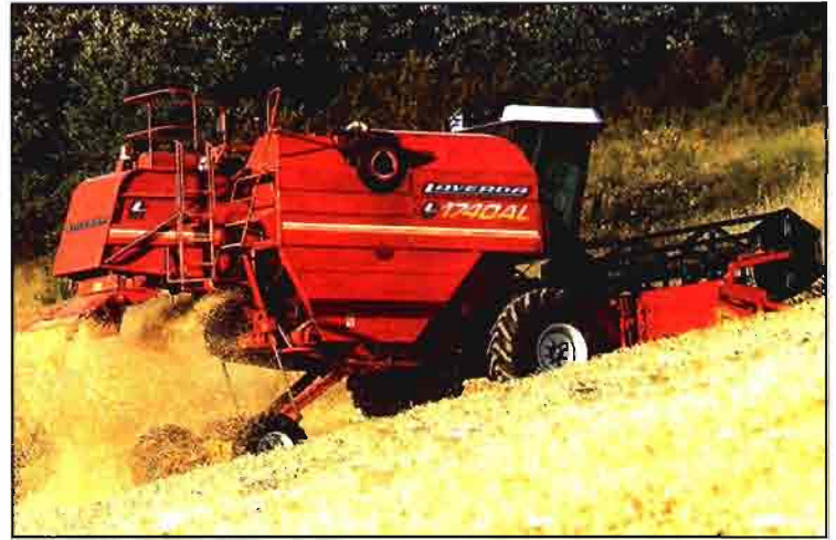
F.3. Algunas cosechadoras autonivelantes permiten trabajar a favor de pendiente colocando todo el cuerpo de la máquina en horizontal, por medio de un sistema hidráulico (Laverda 1740 AL).
