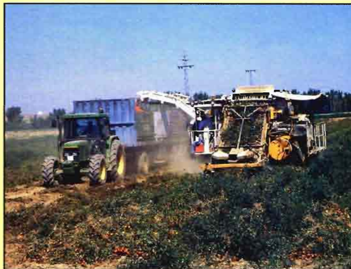
Cosechadora de tomate autopropulsada.
