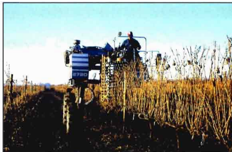
Prepodadora de cepas en espaldera montada delante del chasis de una vendimiadora.
