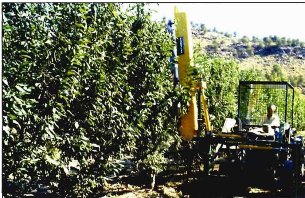
Brazo con cuchillas circulares podando en verde.
