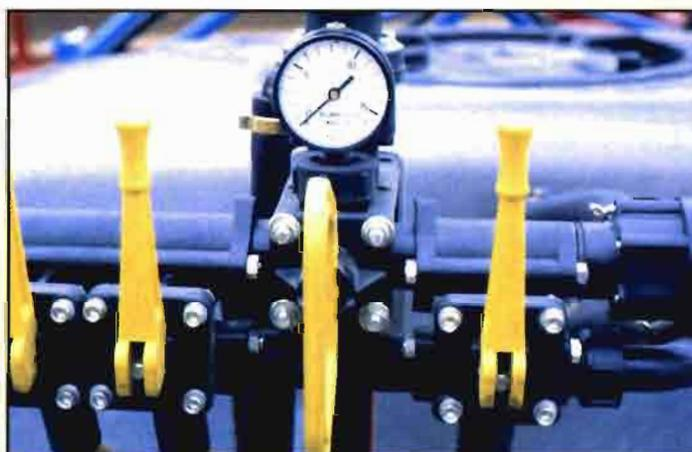
El manómetro ha de ser de baja presión para la aplicación de herbicidas.
